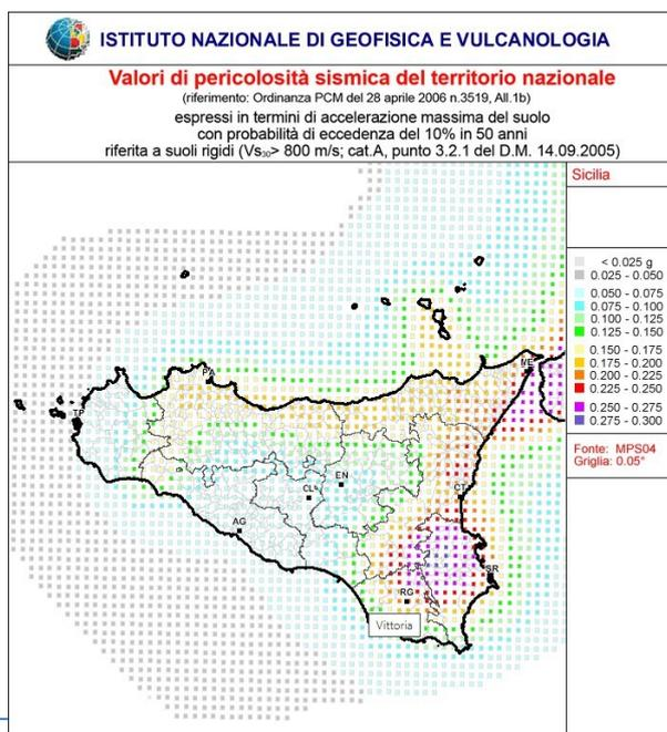
Per ogni opera, ci si deve riferire ad una accelerazione di riferimento “propria”, individuata sulla base delle coordinate geografiche dell’area di progetto e in funzione della vita nominale dell’opera. Questa accelerazione di riferimento verrà rimodulata in funzione delle caratteristiche sismo stratigrafiche e morfologiche del sito di intervento.
