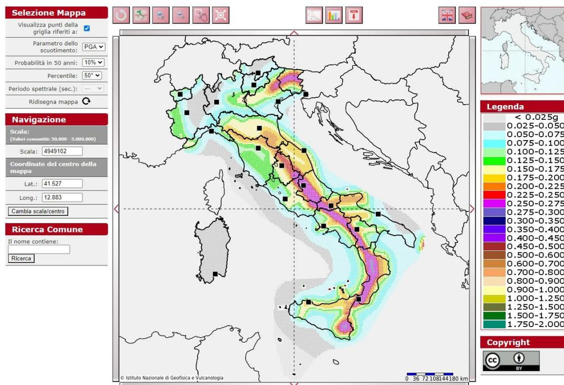
Le azioni di progetto quindi si ricavano, ai sensi delle NTC, dalle accelerazioni  $a_g$  e dalle relative forme spettrali. Le forme spettrali previste nella vigente normativa (NCT) sono definite, per ciascuna delle probabilità di superamento nel periodo di riferimento  $P_vR$ , su sito di riferimento rigido orizzontale, in funzione dei tre parametri seguenti:
