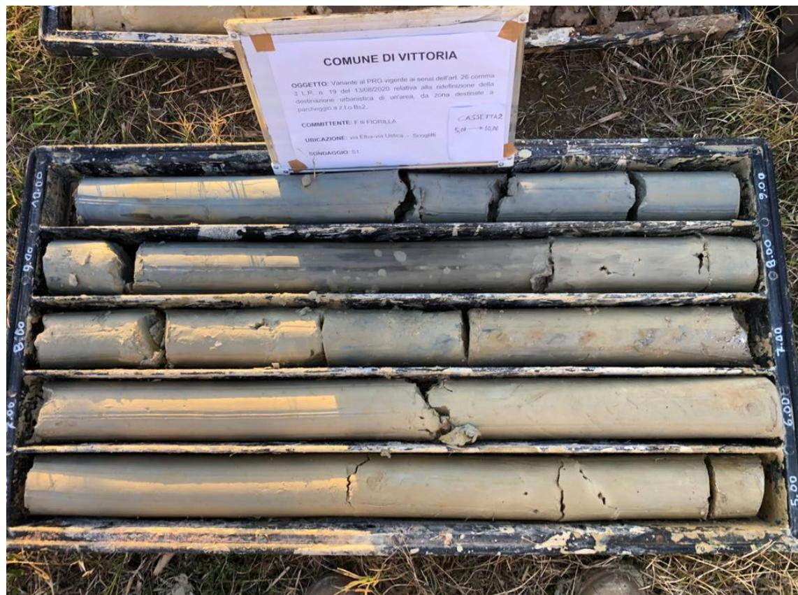
Foto 5: Sondaggio S1 cassetta n. 2 da 5,00 a 10,00 m da p.c.
