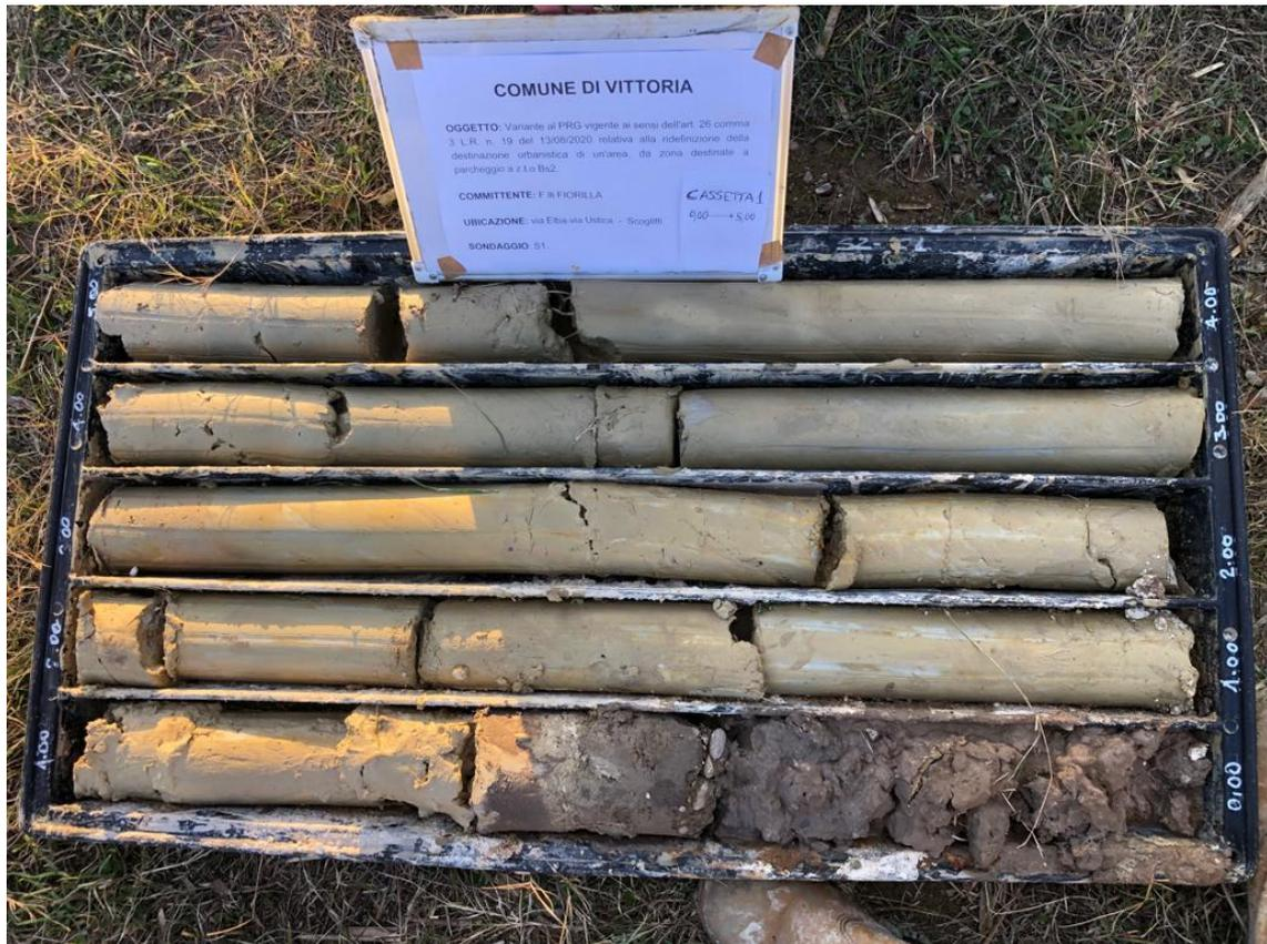
Foto 4: Sondaggio S1 cassetta n. 1 da 0,00 a 5,00 da p.c.
