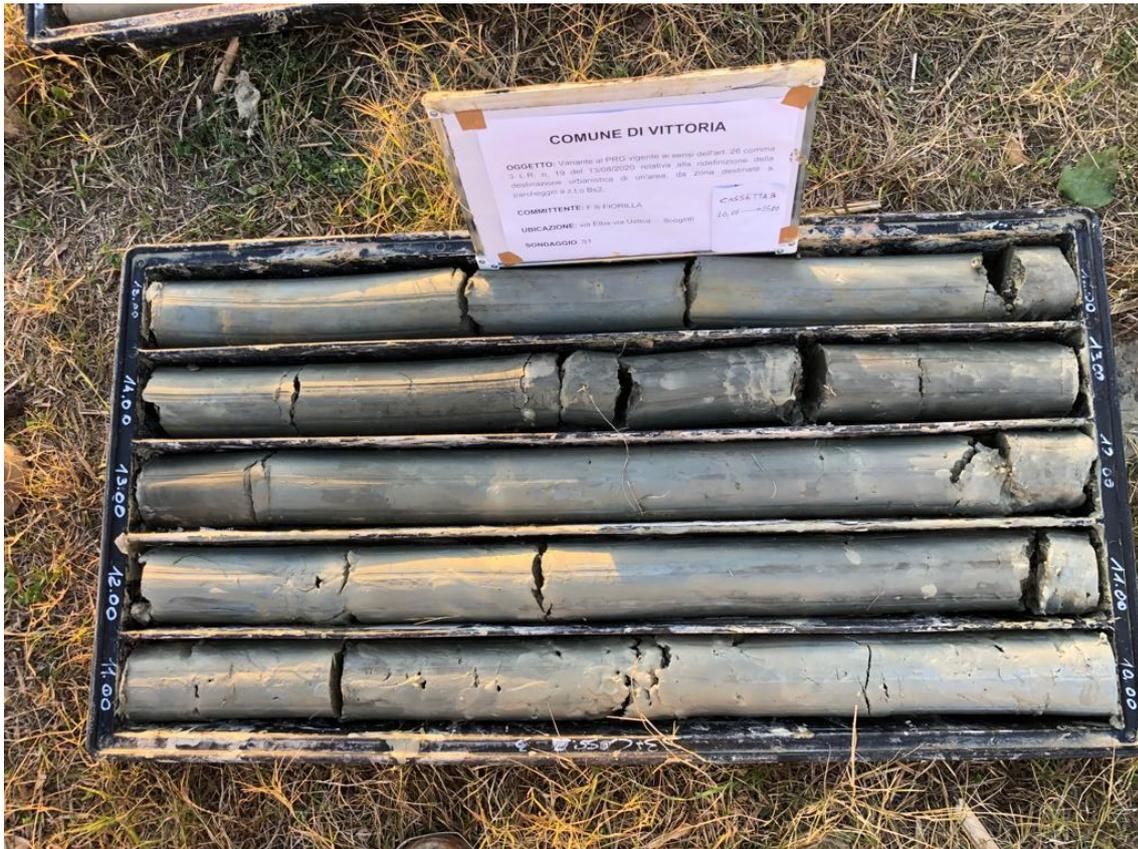
Foto 6: Sondaggio S1 cassetta n. 3 da 10,00 a 15,00 m da p.c.
