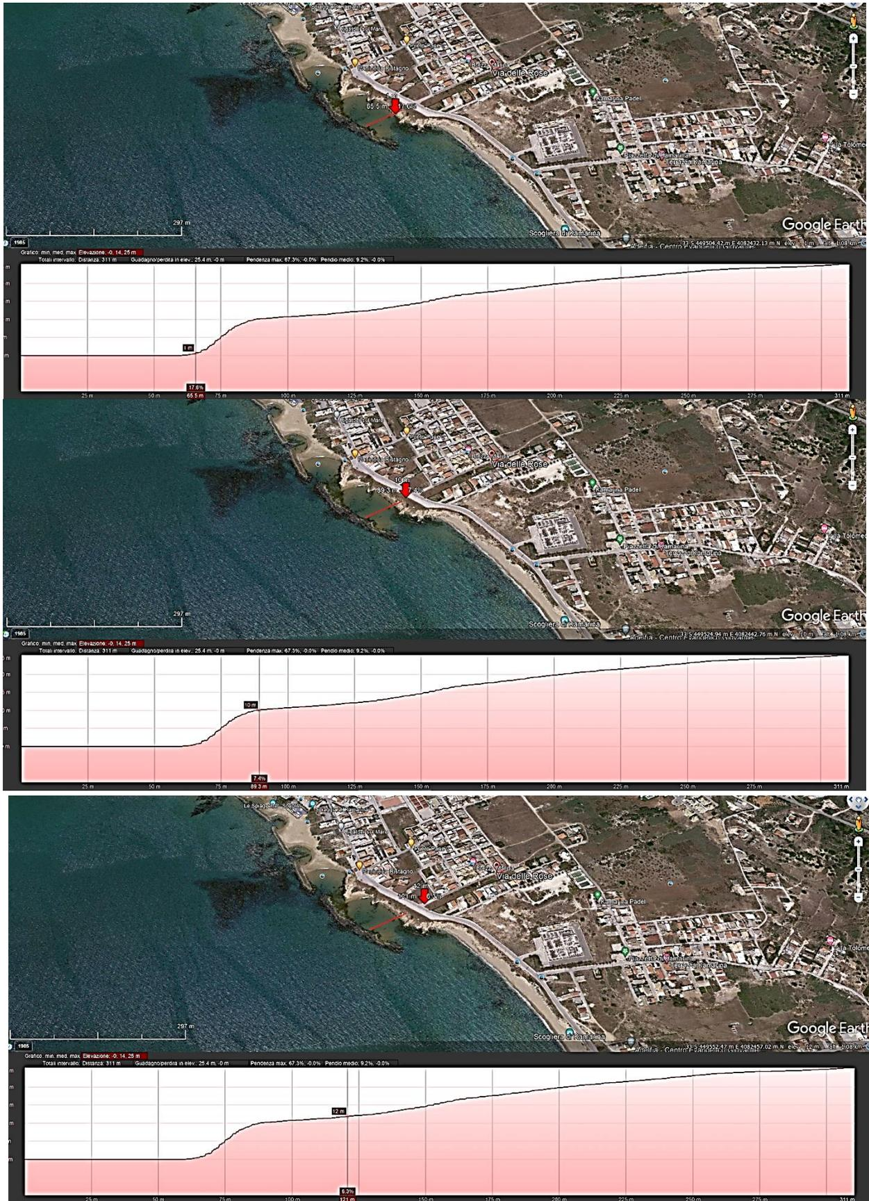
Secondo il profilo altimetrico, tracciato lungo l'asse della via Delle Rose, risulta che la giacitura dei terreni di proprietà della ditta Oliver è posta ad una quota di metri 10 circa slm, che costituisce il dislivello fra i terreni e la sottostante spiaggia del mare. Si rileva inoltre che fra i terreni e la stessa spiaggia del mare è frapposta la strada litoranea Scoglitti-Cammarana .
